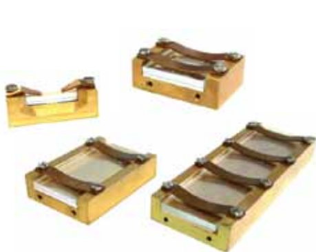
1、10、20和40mm装配在夹具上的MgO:PPLN
